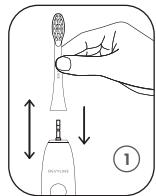
1. Аккуратно наденьте насадку на посадочное место. Оставьте небольшой зазор между насадкой и корпусом, так как зазор необходим для возможности осуществления вибрации.
